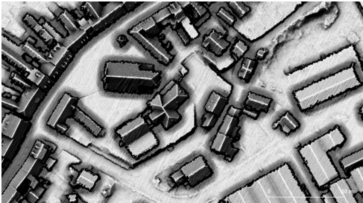
Slika 4: Ponovno izračunani rastrski podatki aerolaserskega skeniranja, ki prikazujejo tla in stavbe.
