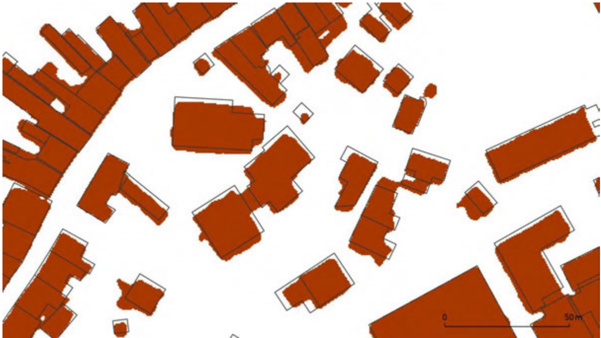
Slika 6: Podatki kjer so z oranžno označene celice, ki pripadajo stavbam, po filtriranju s filtrom mediana. Opaziti je neskladje med katastrom stavb in podatki aerolaserskega skeniranja.
