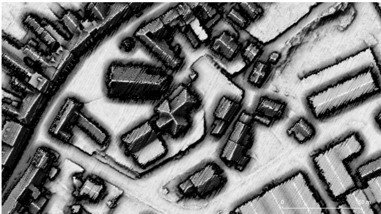
Slika 3: Rastrski podatki aerolaserskega skeniranja, ki prikazujejo tla in stavbe. Način rastriranja, ki lepo ohranja majhne topografske značilnosti, npr. arheološke ostaline, je za izračun nagibov in zasukov delov streh manj primeren, ker so zelo vidni artefakti (npr. črte), ki so posledica lastnosti laserskega skeniranja.
