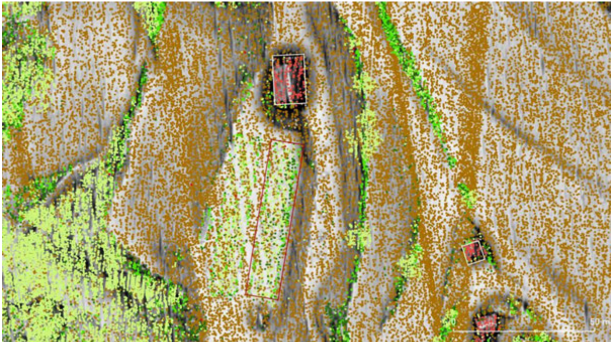
Slika 15: Primer stavbe za katero izračun ni bil uspešen (rdeč pravokotnik), saj v oblaku točk aerolaserskega skeniranja ni označena kot stavba (ni rdečih točk) in zato na rastru stavb ni razvidna. Na sliki je opaziti tudi primer, ko je stavba v oblaku točk označena (desno spodaj), a ni vpisana v kataster stavb. V zelenih tonih so označeni odboji z vegetacije, v rjavih pa odboji s tal.
